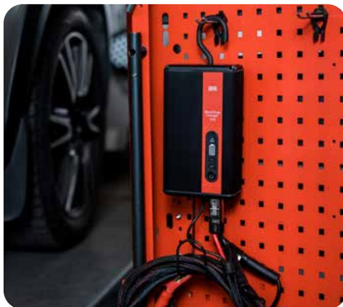
Le chargeur est maintenant en mode alimentation et délivre 13,7 V et jusqu'à 35A.
